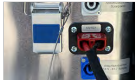
Modifizierter 12 V/50 A Anderson-Anschluss
