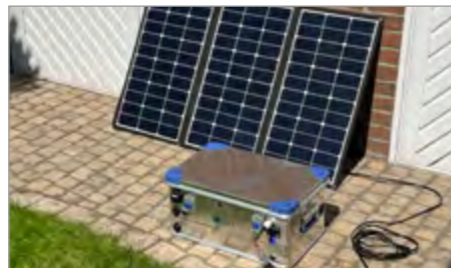
Aufladen der Power Station mit Solarpanel
